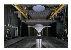
Установка для испытания гибридной конструкции «крыло-фюзеляж» (перевернутой) в аэродинамической трубе с фазированной решеткой из 97 микрофонов (сверху) и микрофонной стойкой (слева).
